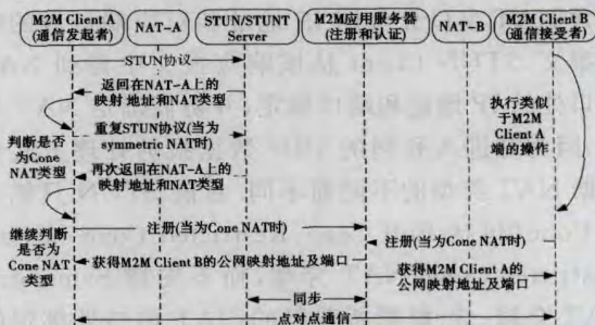
图 5 位于不同 NAT 后的 M2M 设备之间通信的建立过程
